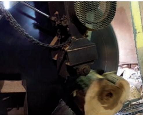
Une scie pendulaire géante de 3,50 m de diamètre débite la grume en billons.
