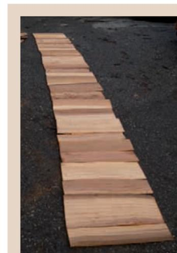
La quantité de shakes dans un paquet est représentée par la longueur développée au sol des shakes après élimination des éventuelles pièces offgrade. Elle doit être de 6,80 m pour les shakes conditionnés 9/9 et de 3,78 m quand le conditionnement est 5/5 (voir le tableau au dos).
